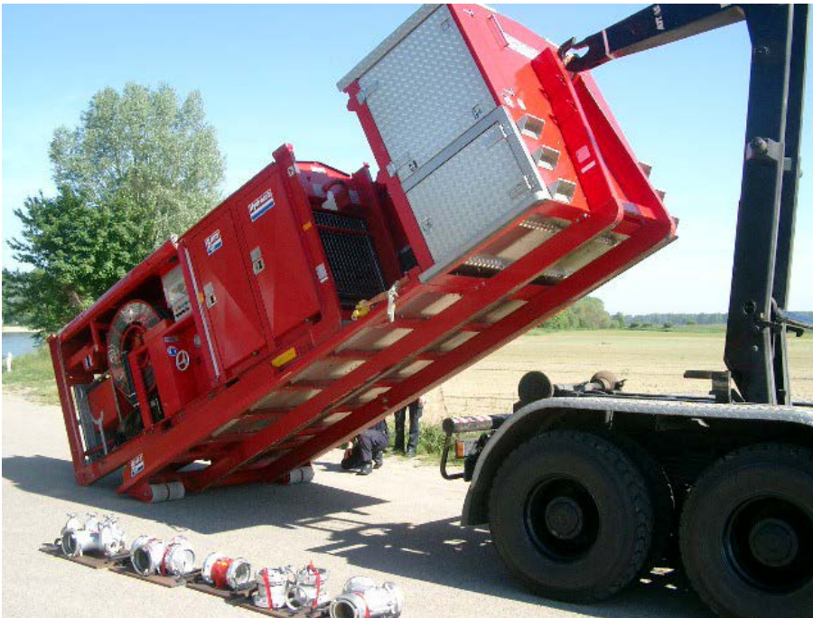
ABB. 18: HFS BEIM ABSETZEN DER PUMPENEINHEIT AN DER WASSERENTNAHMESTELLE
