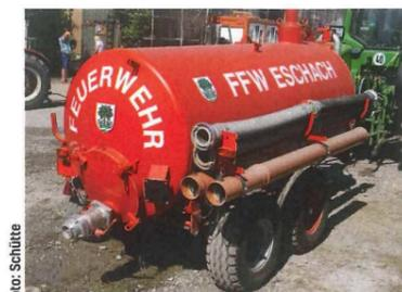
Auf der rechten Seite des Feuerwehr-Pumpfasses sind unterschiedliche Saugschläuche angebracht. Als Zugfahrzeug dient ein Traktor des Bauhofs.
